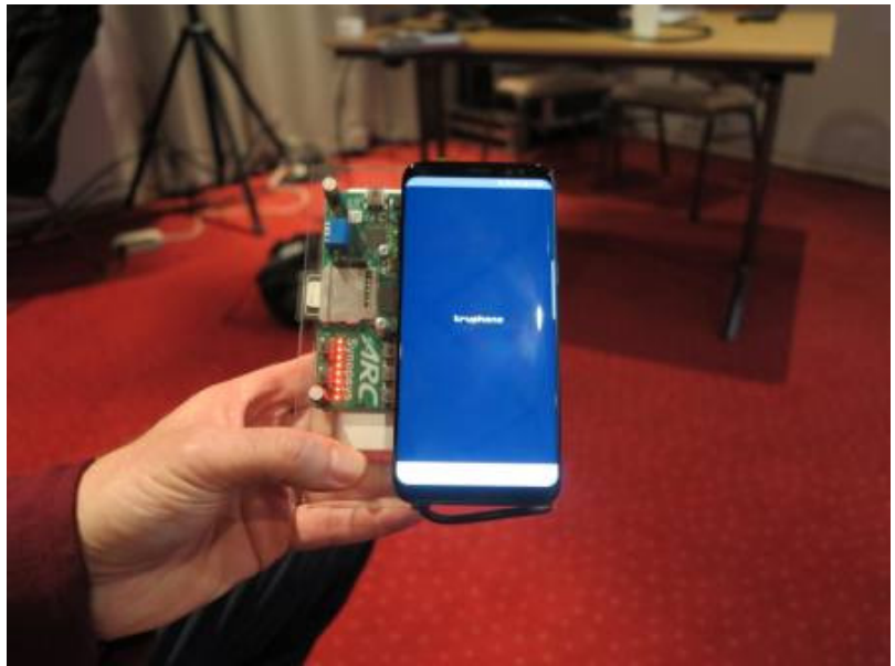
Smartphone med et ARC CPU prototypedesign
